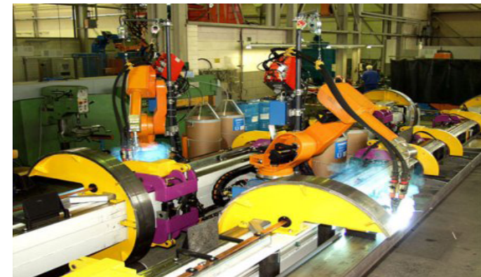
Рисунок 2 – Автоматизированный участок сварки
