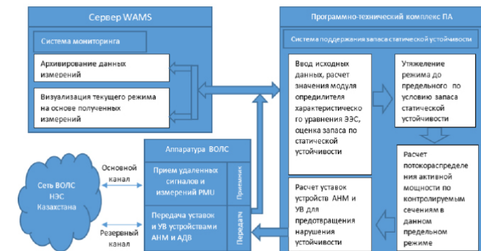
Рисунок 3 – Структурная схема интеграции ЦСПА ЭЭС РК с системой WAMS
